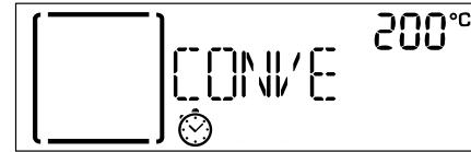
Чтобы выключить таймер, остановите действующий режим, повернув *ручку регулировки* на 0, а затем нажмите .
