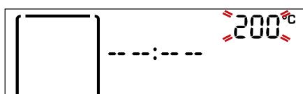
Когда значение на дисплее начнет мигать, поверните ручку регулировки для изменения значения, после чего нажмите OK select для подтверждения выбора и перехода к следующей настройке (при наличии).
