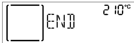
Нажмите *OK select*, чтобы продолжить приготовление в ручном режиме (без задания длительности приготовления), или увеличьте длительность при помощи *ручки регулировки*. В обоих случаях настройки температуры и мощности гриля сохраняются.
