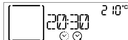
Примечания: Установка отложенного старта отменяет стадию предварительного прогрева духовки. Поскольку духовка выходит на заданную температуру постепенно, время приготовления окажется немного длиннее, чем указано в таблице приготовления.
