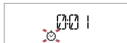
Установите необходимую длительность *ручкой регулировки* и нажмите *OK select* для запуска таймера. В момент окончания таймером обратного отсчета прозвучит звуковой сигнал и на дисплее появится соответствующая индикация.
