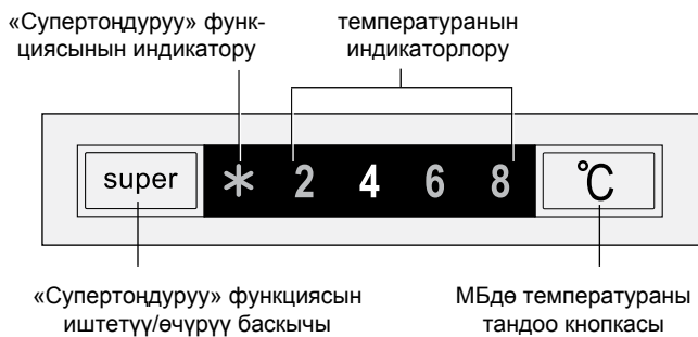
3-сүрөт – Башкаруу панели
