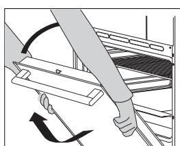
**3** Медленно закрывайте дверцу, пока фиксаторы не упрутся в прорези на дверце. Немного приподнимите дверцу и извлеките из гнезд шарниров.
