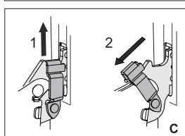
**C** При плавном закрывании дверцы приподнимите фиксаторы и потяните на себя.
