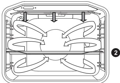
Одновременно работают верхний нагревательный элемент, инфранагреватель и вентилятор.
