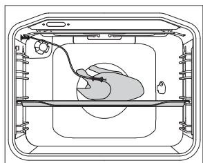
**2** Штекер зонда вставьте в гнездо и воткните зонд в кусок мяса. Если были установлены функции, программирующие время работы прибора, они обнуляются.
