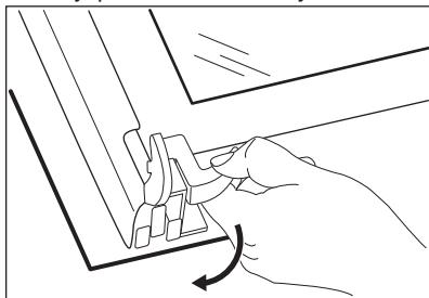
6. Поверните два фиксатора на 90° и извлеките их из своих гнезд.
